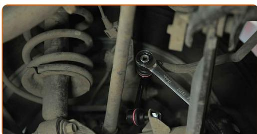
**9** Installez l'attache de la barre au stabilisateur et serrez-la. Utilisez une clé mixte de No.17. Utilisez une douille n° 17. Utilisez la clé HEX n° H6. Utilisez une clé dynamométrique. Serrez-le jusqu'à 38 Nm.
