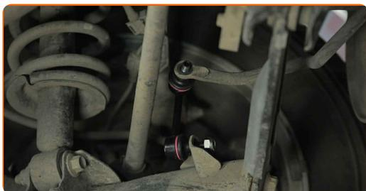
**8** Serrez la fixation reliant la biellette à la barre stabilisatrice. Utilisez une clé mixte de No.17. Utilisez la clé HEX n° H6. Utilisez une clé dynamométrique. Serrez-le jusqu'à 38 Nm.
