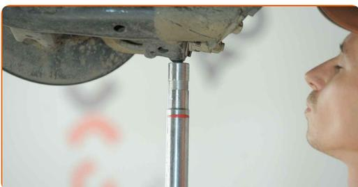
**42** Serrez l'attache inférieure de l'amortisseur. Utilisez une douille n° 17. Utilisez une clé dynamométrique. Serrez-le jusqu'à 93 Nm.
