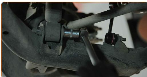
**8** Retirez l'écrou de fixation. Servez-vous d'un pied-de-biche. Utilisez une douille n° 17. Utilisez une clé à cliquet.
