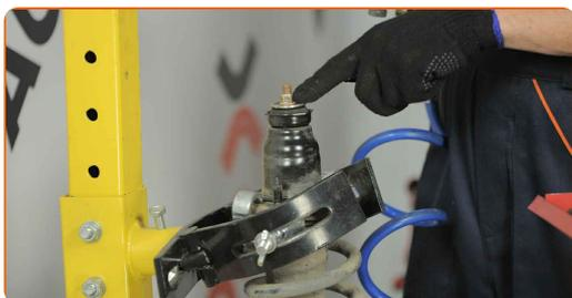
**19** Retirez l'écrou de la tige de piston de l'entretoise. Utilisez une douille n° 14. Utilisez une clé à cliquet.
