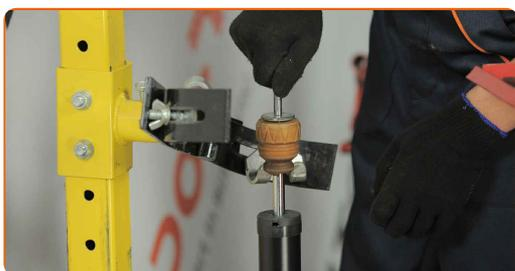
**26** Installez le ressort sur l'amortisseur. Installez la coupelle supérieure de l'amortisseur et son roulement.
