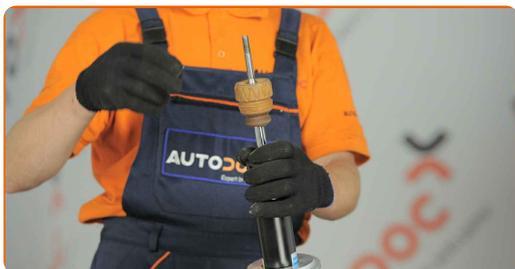
**25** Installez le nouvel amortisseur sur le compresseur à ressort hydraulique hélicoïdal.
