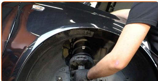
Remplacement : ressort de suspension – Opel Corsa D. AUTODOC recommande :
