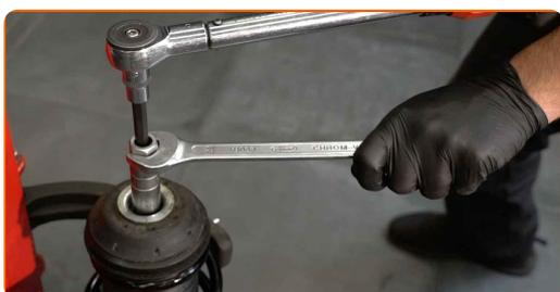
**Remplacement : ressort de suspension – Opel Corsa D. Conseil :**
