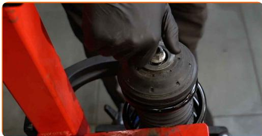
**41** Serrez l'écrou de l'entretoise d'amortisseur due la tige de piston. Utilisez une douille n° 18. Utilisez la mèche Torx T40. Utilisez une clé dynamométrique. Serrez-le jusqu'à 50 Nm.
