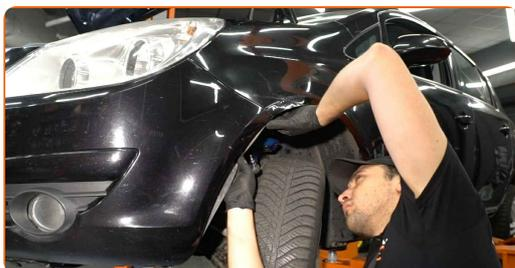
7 Dévissez les fixations inférieures du pare-chocs. Utilisez la mèche Torx T25. Utilisez une clé à cliquet.
