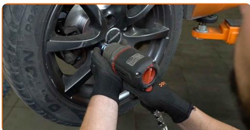
**38** Abaissez la voiture et serrez les boulons de roue en ordre croisé. Servez-vous d'une douille à choc pour roue N°17. Utilisez une clé dynamométrique. Serrez-le jusqu'à 100 Nm.
