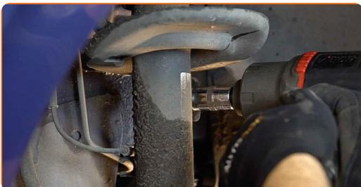
**16** Nettoyez les fixations assurant la connexion entre la jambe d'amortisseur et le porte-fusée. Utilisez une brosse métallique. Servez vous de l'aérosol WD-40.
