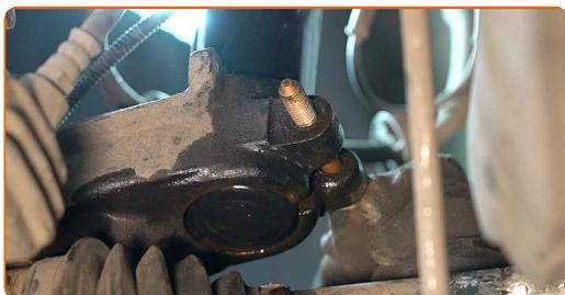
**61** Installez et serrez un nouveau boulon sur la fusée d'essieu.
