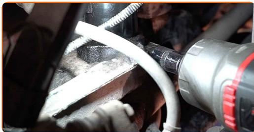
**62** Vissez la fixation reliant le joint à rotule au porte-fusée. Utilisez une douille n° 16. Utilisez une douille n° 18. Utilisez une clé à cliquet.
