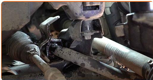
**66** Vissez les fixations des brides de silentblocs de barre stabilisatrice. Utilisez une douille n° 18. Utilisez une clé à cliquet.
