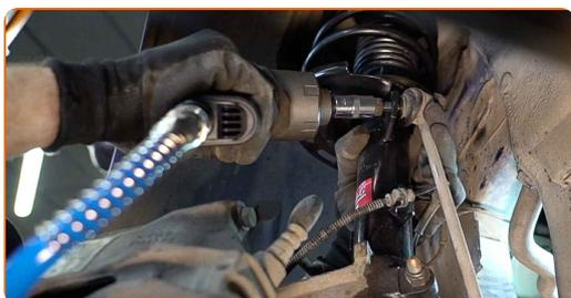
**68** Serrez les fixations inférieures qui relient l'amortisseur à la fusée d'essieu. Utilisez une douille n° 18. Utilisez une clé dynamométrique. Serrez-le jusqu'à 55 Nm.
