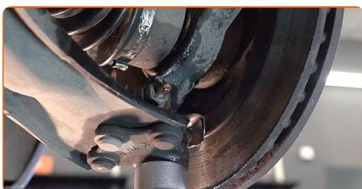
**63** Vissez la fixation qui relie la jambe d'amortisseur à la fusée d'essieu. Utilisez une douille n° 18.
