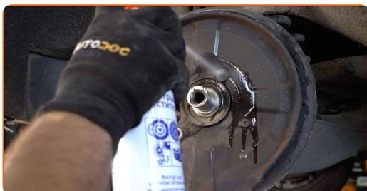
**19** Appliquez du produit sur les boulons de serrage. Utilisez un enduit.
