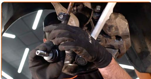
**13** Nettoyez les fixations reliant le bras de commande au sous-châssis. Utilisez une brosse métallique. Servez vous de l'aérosol WD-40.
