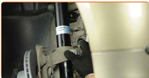
**60** Installez la fixation arrière du bras de commande.
