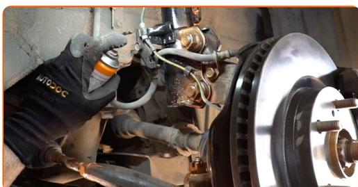
**65** Connectez l'extrémité du tirant à la fusée d'essieu.
