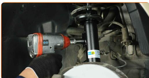
**64** Appliquez du produit sur les fixations de l'amortisseur. Utilisez de la graisse au cuivre.
