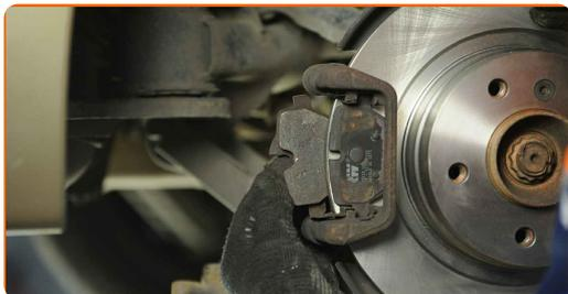
**12** Retirez les clips de retenue des plaquettes de frein. Utilisez un tournevis plat.
