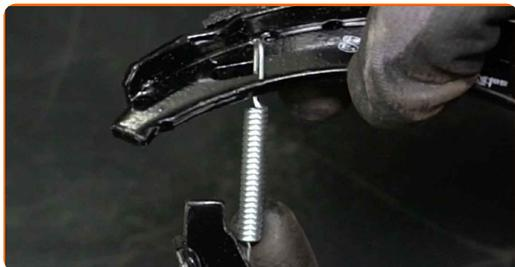
**30** Installez le dispositif de réglage du frein de stationnement.
