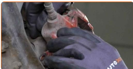
**41** Installez les boulons de fixation.
