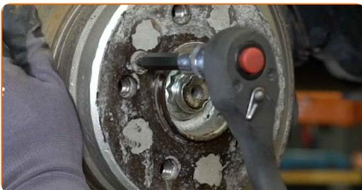
**19** Retirez l'écrou de fixation.
