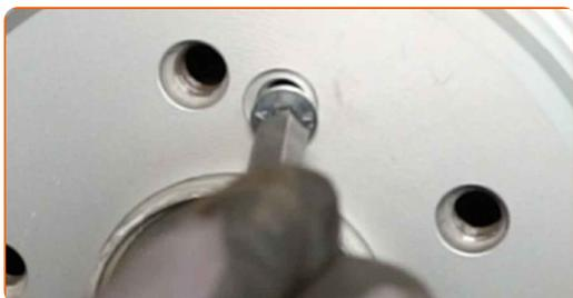
**26** Serrez les fixations du disque de frein. Utilisez la clé HEX n° H5. Utilisez une clé dynamométrique. Serrez-le jusqu'à 10 Nm.
