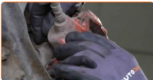
**29** Installez les boulons de fixation.
