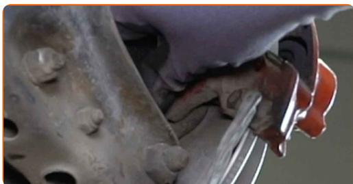
**30** Serrez les fixations de l'étrier de frein. Utilisez une douille n° 17. Utilisez une clé dynamométrique. Serrez-le jusqu'à 65 Nm.
