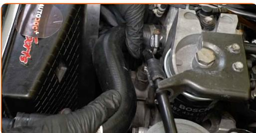
**46** Serrez les colliers de serrage de la durite de refroidissement supérieure. Utilisez une douille n° 7. Utilisez une clé à cliquet.
