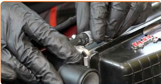
**44** Serrez le collier de serrage du flexible du vase d'expansion. Utilisez une douille n° 7. Utilisez une clé à cliquet.
