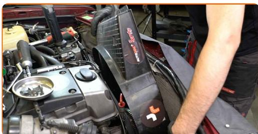
**20** Desserrez le collier de serrage du durite du vase d'expansion. Utilisez une douille n° 7. Utilisez une clé à cliquet.
