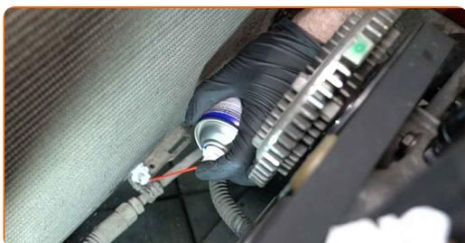
**23** Dévissez la fixation de la conduite de refroidissement inférieure de la transmission automatique. Utilisez une douille n° 10. Utilisez une clé à cliquet.
