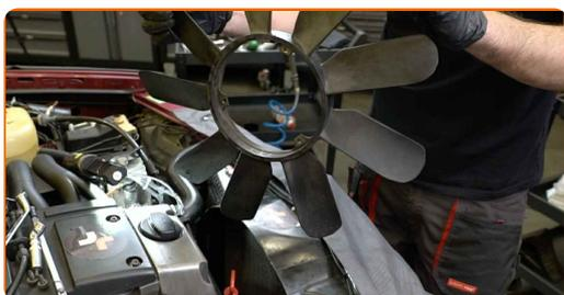
**16** Retirez les clips du capot du ventilateur. Utilisez un outil d'extraction de clips.
