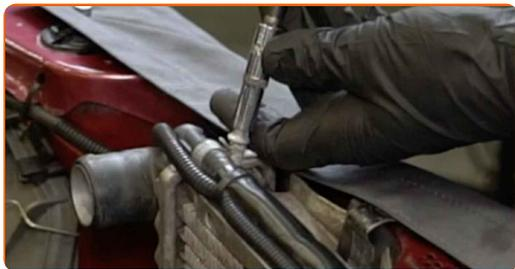
**21** Nettoyez la fixation de durite de refroidissement inférieure de la boîte de vitesse automatique.
