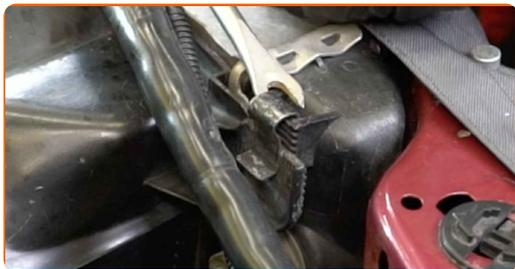
**17** Desserrez les colliers de serrage de la durite de refroidissement supérieure Utilisez une douille n° 7. Utilisez une clé à cliquet.
