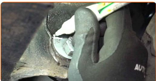
**10** Dévissez la fixation arrière du bras de commande. Utilisez une clé mixte de No.22 Utilisez une douille n° 22. Utilisez une clé à cliquet.
