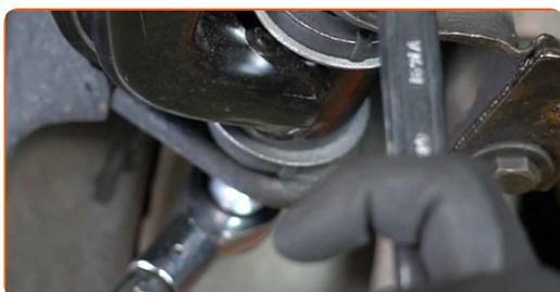
**32** Serrez la fixation avant du bras de commande. Utilisez une clé mixte de No.22 Utilisez une douille n° 22. Utilisez une clé dynamométrique. Serrez-le jusqu'à 120 Nm.
