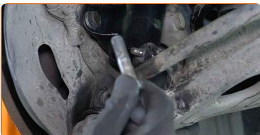
**16** Détachez le joint à rotule de la fusée d'essieu.
