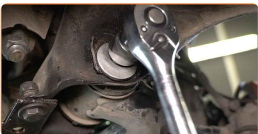
**11** Dévissez la fixation avant du bras de commande. Utilisez une clé mixte de No.22 Utilisez une douille n° 22. Utilisez une clé à cliquet.
