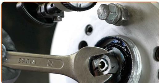
**Remplacement : roulement de roue – Mercedes W124. Conseil :**
