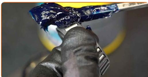
**29** Réinstallez les éléments des roulements dans le moyeu de roue.
