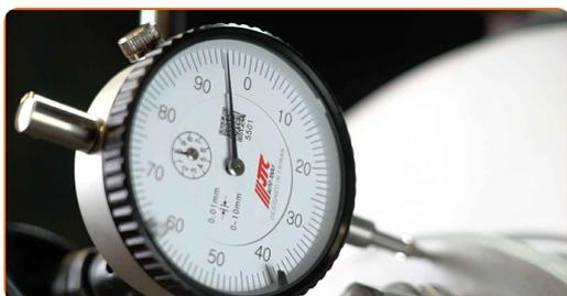
**38** Réglez le jeu axial en serrant l'écrou de réglage. Utilisez une clé mixte de No.22
