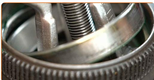
**26** Nettoyez les sièges de montage des roulements de roue. Servez-vous d'un aérosol nettoyant multi-usages.
