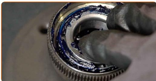
**30** Installez le joint d'huile du roulement de roue. Utilisez un coffret de douilles et de roulements.
