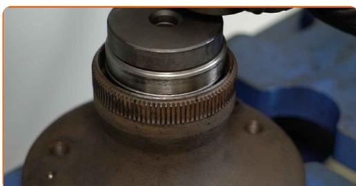
**28** Appliquez du produit sur les roulements de roue. Utilisez de la graisse pour roulements.
