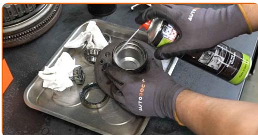
**27** Installez les bagues extérieures des nouveaux roulements de roue. Utilisez un coffret de douilles et de roulements.
