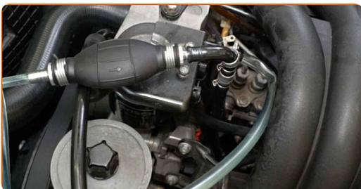
**15** Serrez le collier de serrage du tuyau du filtre à carburant. Servez-vous d'un tournevis Phillips.
