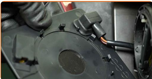
5 Détachez le connecteur du chauffage de rétroviseur.
