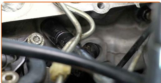
Remplacement : bougie de préchauffage – Mercedes W124. AUTODOC recommande :
