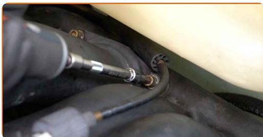
**57** Installez les boulons de fixation.
