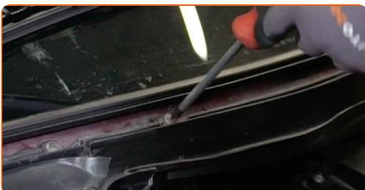
**15** Installez la moulure en caoutchouc du pare-brise.
