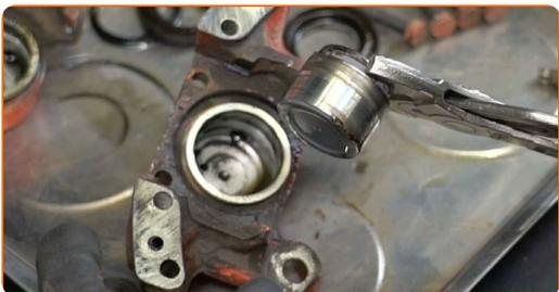
**29** Retirez les joints toriques du piston. Utilisez un tournevis plat.
