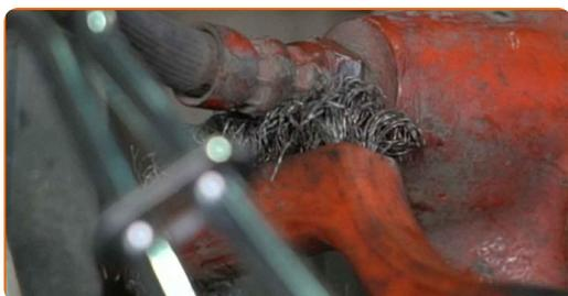
**15** Desserrez la fixation du flexible de frein. Utilisez une clé mixte de No.14
