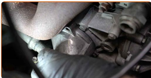
**26** Installez les boulons de fixation.
