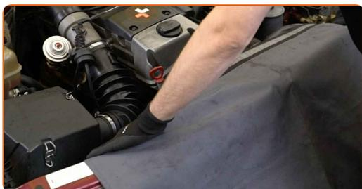
**3** Desserrez les colliers de serrage des tuyaux du filtre à air. Utilisez une douille n° 7. Utilisez une clé à cliquet.
