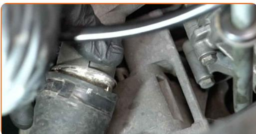
Remplacement : sonde de température et calorstat – Mercedes W124.
