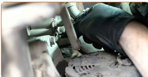
**18** Desserrez le collier de serrage du tuyau de refroidissement. Utilisez une douille n° 7. Utilisez une clé à cliquet.
