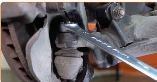
**8** Dévissez les fixations qui lient le joint à rotule au bras de contrôle de suspension. Utilisez une douille n° 22. Utilisez une clé à cliquet.
