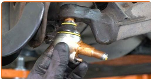
**15** Attachez le joint à rotule au bras de contrôle.
