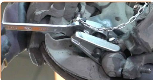
**10** Détachez le joint à rotule de la fusée d'essieu. Servez-vous d'un extracteur de rotules.
