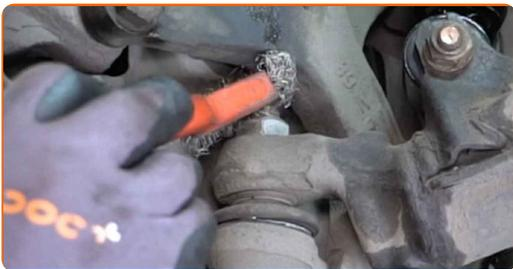
**7** Dévissez la fixation connectant le joint à rotule à la fusée d'essieu. Utilisez une clé mixte de No.22.
