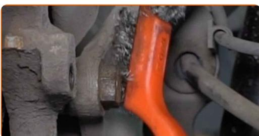
**16** Dévissez les fixations du support d'étrier de frein. Utilisez une douille n° 18. Utilisez une clé à cliquet.
