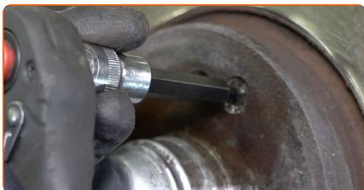
**21** Retirez l'écrou de fixation.
