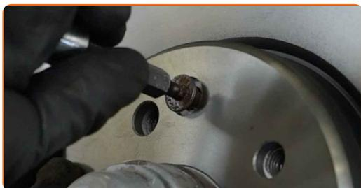
**27** Serrez les fixations du disque de frein. Utilisez la clé HEX n° H5. Utilisez une clé dynamométrique. Serrez-le jusqu'à 10 Nm.
