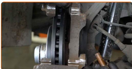
**30** Installez les boulons de fixation.
