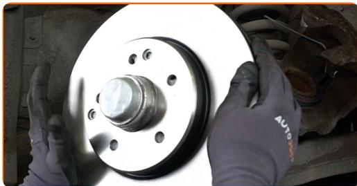
**26** Installez l'écrou de fixation.
