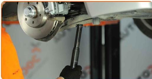
**25** Serrez l'attache inférieure de l'amortisseur. Utilisez une clé mixte de No.17 Utilisez une douille n° 17. Utilisez une clé dynamométrique. Serrez-le jusqu'à 55 Nm.
