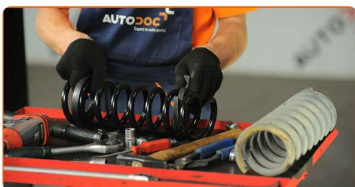
Remplacement : ressort de suspension – Mercedes W210. Les experts d'AUTODOC recommandent :
