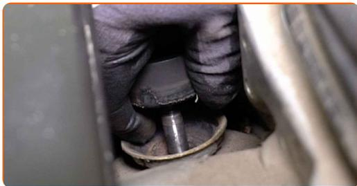
**16** Retirez l'écrou de fixation.
