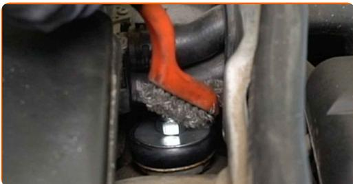
**5** Relâchez la fixation supérieure de l'amortisseur. Servez-vous d'une douille spéciale pour retirer l'amortisseur n°16. Servez-vous d'un embout d'amortisseur n°DD6. Utilisez une clé à cliquet.
