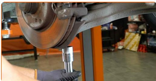
**13** Dévissez les fixations inférieures de l'amortisseur. Utilisez une clé mixte de No.17. Utilisez une douille n° 17. Utilisez une clé à cliquet.
