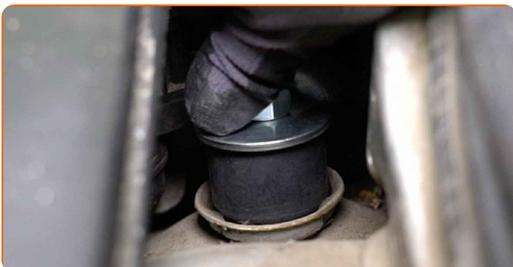
**23** Installez l'écrou de fixation.
