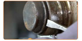
Desserrez l'écrou de fixation du moyeu de roue. Utilisez la mèche Torx T40. Utilisez une clé à cliquet.
