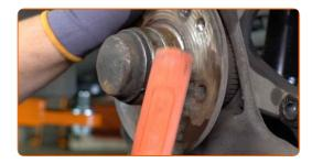
Retirez le bouchon du roulement de moyeu. Servez-vous d'un pied-de-biche.
