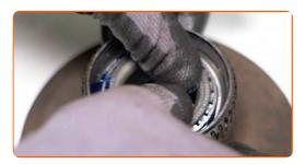
Installez le joint d'huile du roulement de roue. Utilisez un coffret de douilles et de roulements.
