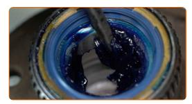
Réinstallez le moyeu de roue avec les nouveaux roulements.
