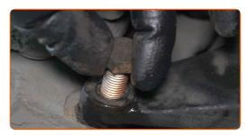
Serrez les fixations du support d'étrier de frein. Utilisez une douille n° 18. Utilisez une clé dynamométrique. Serrez-le jusqu'à 115 Nm.
