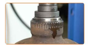
Nettoyez les sièges de montage des roulements de roue. Servez-vous d'un aérosol nettoyant multi-usages.
