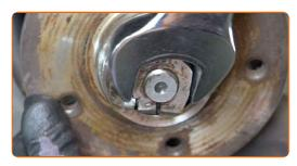
Retirez le moyeu de roue avec les roulements.
