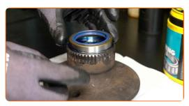
Appliquez du produit sur la fusée d'essieu. Utilisez de la graisse pour roulements.
