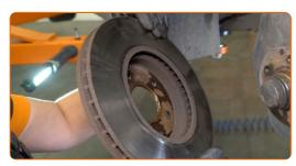
Nettoyez le bouchon de protection du roulement de moyeu. Utilisez une brosse métallique. Servez vous de l'aérosol WD-40.
