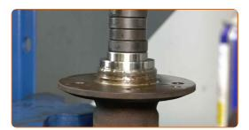
Appliquez du produit sur les roulements de roue. Utilisez de la graisse pour roulements.
