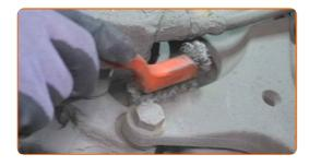
Dévissez les fixations du support d'étrier de frein. Utilisez une douille n° 18. Utilisez une clé à cliquet.
