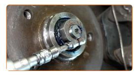
Placez le bouchon du roulement de moyeu. Utilisez un coffret de douilles et de roulements.
