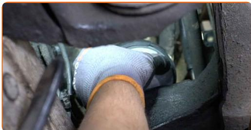
**13** Installez l'écrou de fixation.
