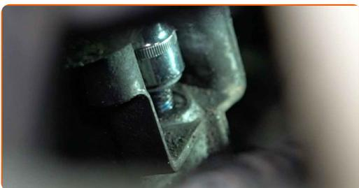
**6** Retirez l'écrou de fixation. Servez-vous du doigt magnétique télescopique.
