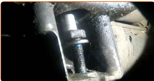
**7** Dévissez la fixation inférieure du support moteur. Utilisez une douille n° 13. Utilisez une clé à cliquet.
