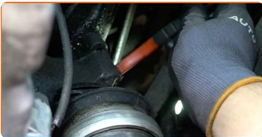
**5** Dévissez la fixation supérieure du support moteur. Utilisez une douille n° 16. Utilisez une clé à cliquet.
