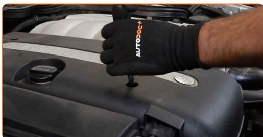
**4** Dévissez les fixations de la partie arrière du capot du moteur. Utilisez une douille n° 10. Utilisez une clé à cliquet.
