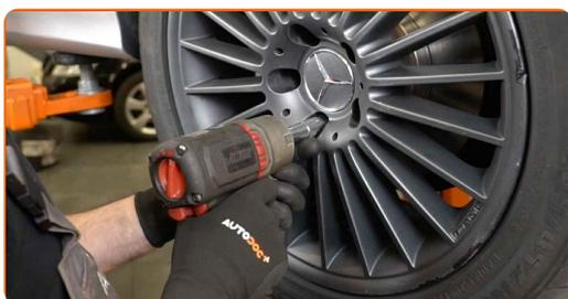
**39** Abaissez la voiture et serrez les boulons de roue en ordre croisé. Servez-vous d'une douille à choc pour roue N°17. Utilisez une clé dynamométrique. Serrez-le jusqu'à 130 Nm.
