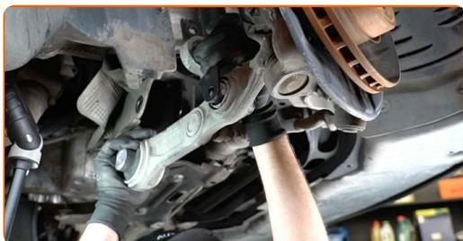
**46** Resserez la fixation de la biellette de la barre stabilisatrice. Utilisez une clé mixte de No.21. Utilisez la clé HEX n° H12. Utilisez une clé à cliquet.
