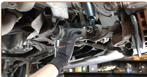
**51** Installez l'écrou de fixation.
