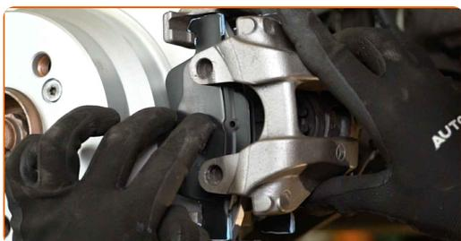
**24** Installez les bouchons anti-poussière des goupilles de guidage de l'étrier de frein.
