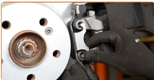
**26** Connectez le capteur d'usure des plaquettes de frein.
