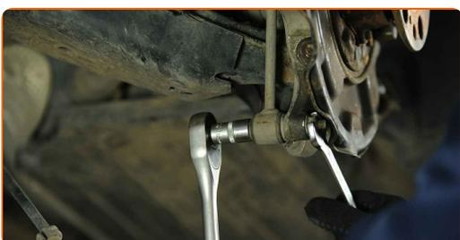
**25** Retirez l'écrou de fixation.
