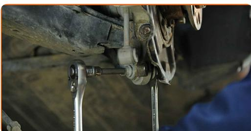
**28** Retirez l'écrou de fixation. Utilisez la mèche Torx M12. Utilisez une clé à cliquet.
