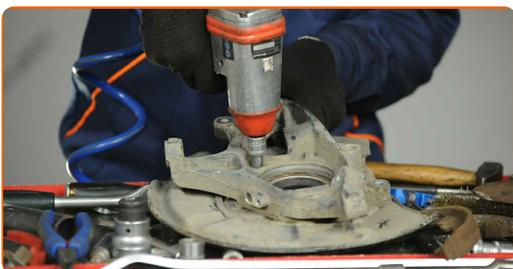
**45** Retirez le support du roulement de moyeu. Servez-vous d'un marteau.
