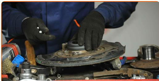
**48** Serrez la fixation du palier de moyeu de roue. Utilisez une douille n° E12. Utilisez une clé dynamométrique. Serrez-le jusqu'à 80 Nm.
