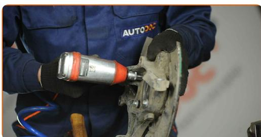
**49** Traitez les attaches du roulement de moyeu de roue. Utilisez de la graisse au cuivre.
