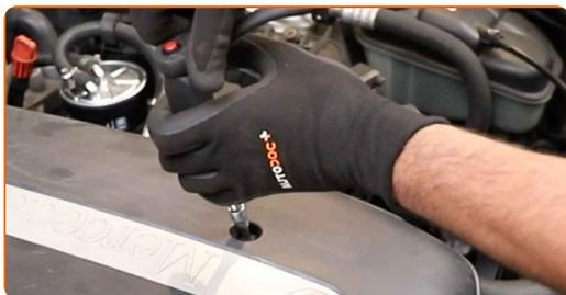
16 Remettez en place la partie arrière du capot du moteur.
