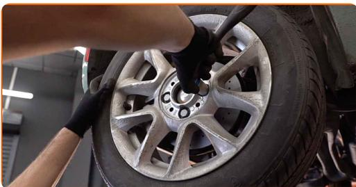
**21** Abaissez la voiture et serrez les boulons de roue en ordre croisé. Utilisez une clé dynamométrique. Serrez-le jusqu'à 98 Nm.
