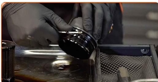
**18** Installez une nouvelle bague d'étanchéité sur l'emplacement du filtre à huile.
