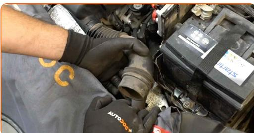
**4** Desserrez les trois vis de fixation du couvercle de filtre à air. Utilisez une douille n° 10. Utilisez une clé à cliquet.
