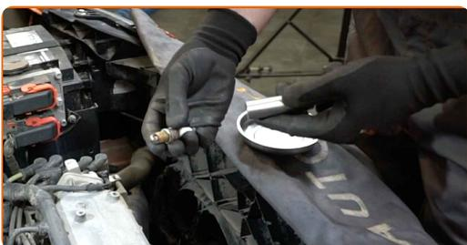
**12** Appliquez une fine couche d'antigrippant à haute température sur les fils des nouvelles bougies d'allumage.
