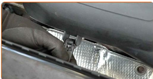
**20** Connectez le tuyau d'admission d'air au boîtier du filtre à air.
