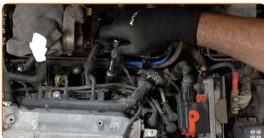
**14** Vissez les nouvelles bougies et serrez-les. Servez-vous de la douille de bougie d'allumage n°16. Utilisez une clé dynamométrique. Serrez-le jusqu'à 25 Nm.
