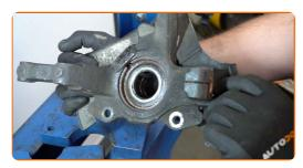
Faites sortir le palier du moyeu de roue. Servez-vous d'un coffret de douilles et de roulements.
