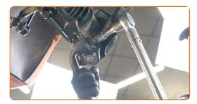
Serrez les fixations inférieures qui relient l'amortisseur à la fusée d'essieu. Utilisez une clé mixte de No.15 Utilisez une douille n° 17. Utilisez une clé dynamométrique. Serrez-le jusqu'à 75 Nm.
