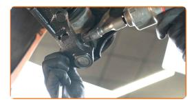
Serrez l'attache du joint rotule. Utilisez une clé mixte de No.13 Utilisez une douille n° 16. Utilisez une clé dynamométrique. Serrez-le jusqu'à 32 Nm.
