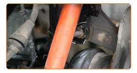
Dévissez les fixations reliant la jambe de suspension à la fusée d'essieu. Utilisez une clé mixte de No.15 Utilisez une douille n° 17. Utilisez une clé à cliquet.
