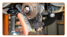
Appliquez du produit sur la fixation du capteur ABS. Servez-vous d'une graisse multi-usages.
