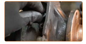
Vissez la fixation reliant le capteur ABS à la fusée d'essieu. Utilisez la clé HEX n° H5. Utilisez une clé dynamométrique. Serrez-le jusqu'à 7 Nm.
