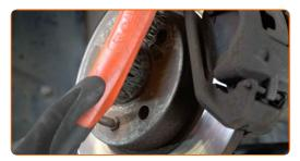
Dessertissez la fixation de l'arbre de transmission. Servez-vous d'un burin plat pour l'usinage des métaux. Servezvous d'un marteau.
