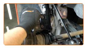
Installez les boulons de fixation.
