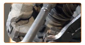
Appliquez du produit sur les fixations de l'amortisseur. Appliquez du produit sur la fixation reliant l'embout de biellette de direction à la fusée d'essieu. Appliquez du produit sur les fixations de la rotule. Utilisez de la graisse au cuivre.
