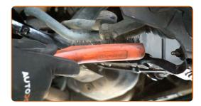
Dévissez l'écrou d'attache d'extrémité à la fusée d'essieu. Utilisez une douille n° 17. Utilisez une clé à cliquet.
