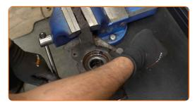
Retirez l'anneau de retenue du palier de moyeu de roue. Servez-vous d'un tournevis plat (2 pièces).
