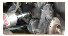
58 Installez l'écrou de fixation.
