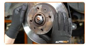
Serrez l'attache du disque de frein. Utilisez une douille n° 12. Utilisez une clé dynamométrique. Serrez-le jusqu'à 9 Nm.
