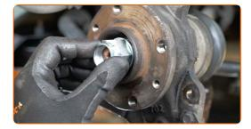
Vissez l'écrou à l'arbre d'entrainement. Utilisez une douille n° 32. Utilisez une clé à cliquet.
