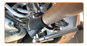
65 Installez l'écrou de fixation.
