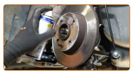
Dévissez l'attache du disque de frein. Utilisez une douille n° 12. Utilisez une clé à cliquet.
