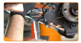
Serrez l'écrou de fixation reliant l'embout de biellette de direction à la fusée d'essieu. Utilisez une douille n° 17. Utilisez une clé dynamométrique. Serrez-le jusqu'à 40 Nm.
