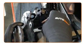
Vissez les fixations reliant la jambe de suspension à la fusée d'essieu. Utilisez une clé mixte de No.15 Utilisez une douille n° 17. Utilisez une clé à cliquet.
