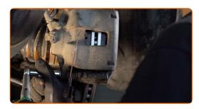
Connectez le connecteur du capteur d'usure de la plaquette de frein.
