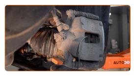
Dévissez l'attache de l'étrier de frein. Utilisez une douille n° 13. Utilisez une clé à cliquet.
