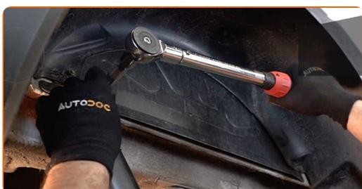
**18** Serrez l'attache inférieure de l'amortisseur. Utilisez une douille n° 21. Utilisez une clé mixte de No.21. Utilisez une clé dynamométrique. Serrez-le jusqu'à 110 Nm.
