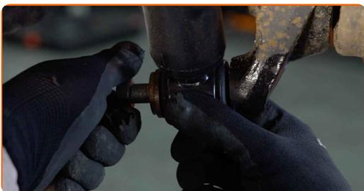
**15** Vissez la fixation inférieure de l'amortisseur. Utilisez une douille n° 21.
