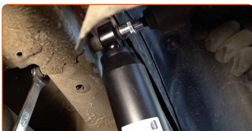
**17** Serrez l'attache de l'amortisseur supérieur. Utilisez une douille n° 18. Utilisez une clé dynamométrique. Serrez-le jusqu'à 50 Nm.
