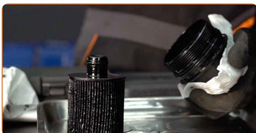
**17** Retirez la bague d'étanchéité du boîtier du filtre à huile. Utilisez un tournevis plat.
