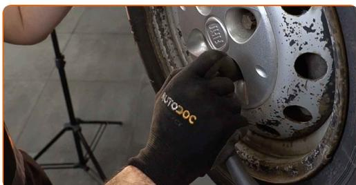
**22** Abaissez la voiture et serrez les boulons de roue en ordre croisé. Utilisez une clé dynamométrique. Serrez-les jusqu'à 98 Nm.
