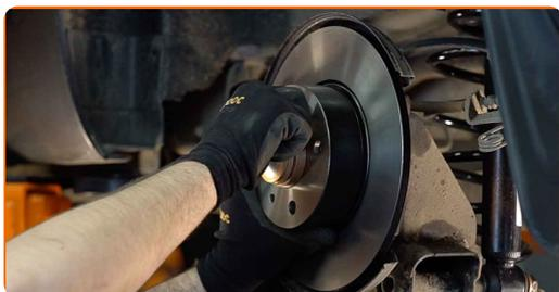
**25** Serrez l'attache du disque de frein. Utilisez une douille n° 12. Utilisez une clé dynamométrique. Serrez-le jusqu'à 10 Nm.
