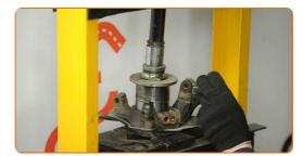
Serrez les fixations inférieures qui relient l'amortisseur à la fusée d'essieu. Utilisez une clé mixte de No.17. Utilisez une douille n° 17. Utilisez une clé dynamométrique. Serrez-le jusqu'à 75 Nm.
