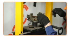
Appuyez sur le roulement neuf pour l'insérer dans la fusée d'essieu.
