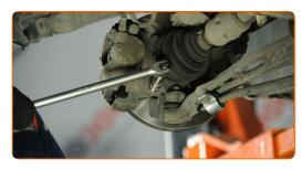
6.2 Utilisez une douille n° 17. Utilisez une clé à cliquet. Utilisez un porte-taraud.
