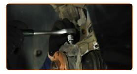
Relâchez la fixation reliant le joint à rotule au porte-fusée. Servez-vous d'un burin plat pour l'usinage des métaux. Servez-vous d'un marteau.
