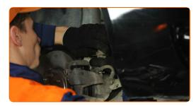
Connectez le tirant à la fusée d'essieu et serrez-le. Utilisez une douille n° 17. Utilisez une clé dynamométrique. Serrez-le jusqu'à 40 Nm.
