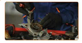
Faites sortir le palier du moyeu de roue.
