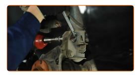
Dévissez l'attache entre le joint rotule et la fusée d'essieu. Utilisez une clé mixte de No.13. Utilisez une douille n° 13. Utilisez une clé à cliquet.
