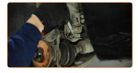
Installez le capteur ABS sur la fusée d'essieu, et sécurisez-le. Utilisez une douille n° 10.
