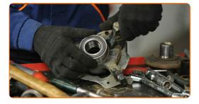
Installez la bague de rétention dans la fusée d'essieu. Utilisez un tournevis plat.
