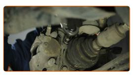
39.3 Utilisez une clé dynamométrique. Respecter bien le couple de serrage recommandé.
