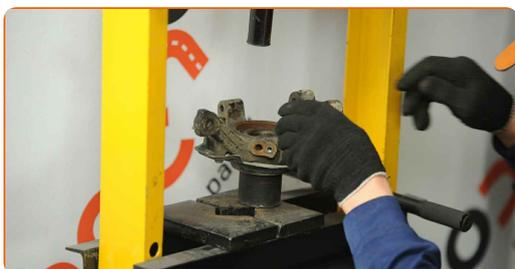
**27** Appuyez sur le roulement neuf pour l'insérer dans la fusée d'essieu.
