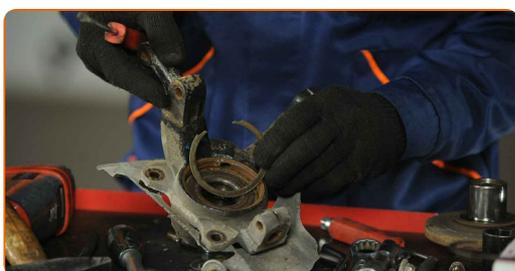
**26** Faites sortir le palier du moyeu de roue.
