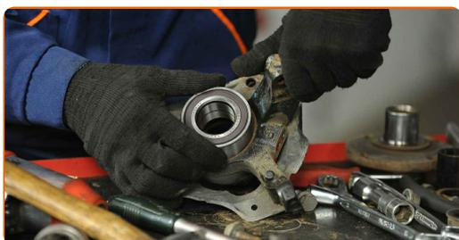
**28** Installez la bague de rétention dans la fusée d'essieu. Utilisez un tournevis plat.
