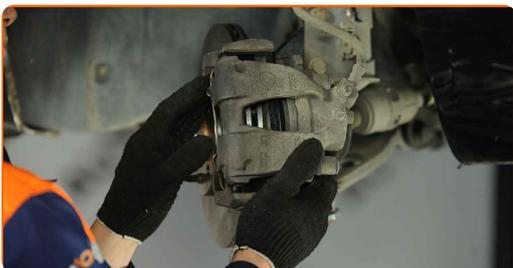
**39.2** Serrez les fixations du support d'étrier de frein. Utilisez une douille n° 12.
