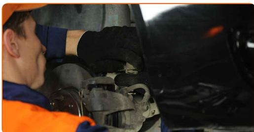
**41** Connectez le tirant à la fusée d'essieu et serrez-le. Utilisez une douille n° 17. Utilisez une clé dynamométrique. Serrez-le jusqu'à 40 Nm.
