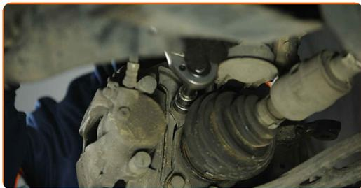
**39.3** Utilisez une clé dynamométrique. Respecter bien le couple de serrage recommandé.
