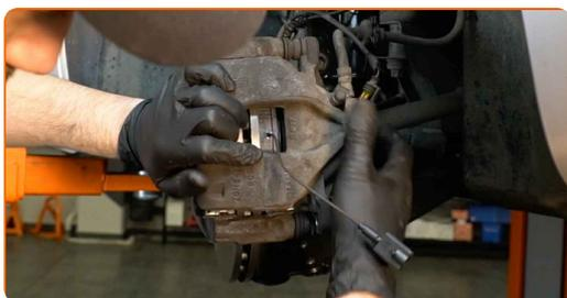
**19** Connectez le capteur d'usure des plaquettes de frein.
