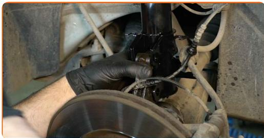
**44** Installez les boulons de fixation.
