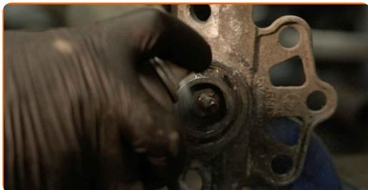
**17** Retirez l'attache de la tige du piston de l'amortisseur. Servez-vous d'un embout d'amortisseur DDN<sup>®</sup>6. Utilisez une douille n° 16. Utilisez une clé à cliquet.
