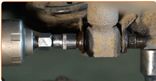
**11** Dévissez l'attache supérieure de l'amortisseur. Utilisez une douille n° E16. Utilisez une clé à cliquet.
