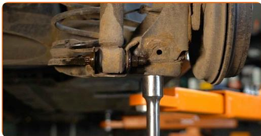
**10** Dévissez l'attache inférieure de l'amortisseur. Utilisez une douille n° E18. Utilisez une clé à cliquet.
