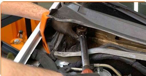
**61** Lubrifiez les fixations de la coupelle d'amortisseur. Utilisez de la graisse au cuivre.
