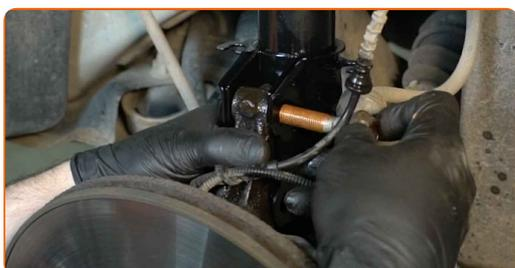
**47** Vissez la fixation qui relie la jambe d'amortisseur à la fusée d'essieu. Utilisez une clé mixte de No.18. Utilisez une douille n° 18. Utilisez une clé à cliquet.
