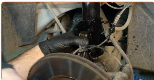
**46** Installez les boulons de fixation.
