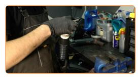
Serrez l'écrou de la tige de l'amortisseur. Servez-vous d'un embout d'amortisseur DDNº6. Utilisez une douille n° 16. Utilisez une clé dynamométrique. Serrez-le jusqu'à 35 Nm.
