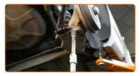
Serrez l'attache de l'amortisseur supérieur. Utilisez une douille n° E16. Utilisez une clé dynamométrique. Serrez-le jusqu'à 72 Nm.
