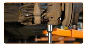
Dévissez l'attache inférieure de l'amortisseur. Utilisez une douille n° E18. Utilisez une clé à cliquet.
