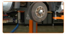
Dévissez les fixations de la garniture de passage de roue. Utilisez une douille n° 10. Utilisez une clé à cliquet.
