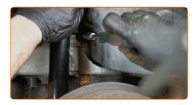
Serrez l'attache inférieure de l'amortisseur. Utilisez une douille n° E18. Utilisez une clé dynamométrique. Serrez-le jusqu'à 120 Nm.
