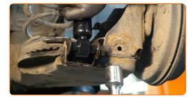
26 Installez l'écrou de fixation.
