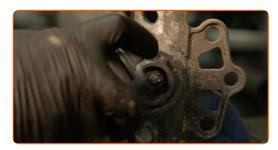
Retirez l'attache de la tige du piston de l'amortisseur. Servez-vous d'un embout d'amortisseur DDNº6. Utilisez une douille n° 16. Utilisez une clé à cliquet.
