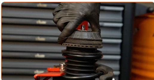
**36** Serrez l'écrou de l'entretoise d'amortisseur due la tige de piston. Utilisez la clé HEX n° H8. Utilisez une douille n° 17. Utilisez une clé dynamométrique. Serrez-le jusqu'à 44 Nm.
