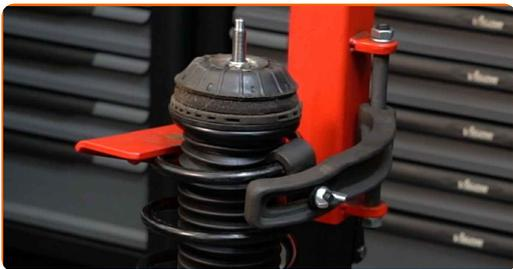
**38** Lubrifiez la barre d'amortisseur. Utilisez de la graisse au cuivre.
