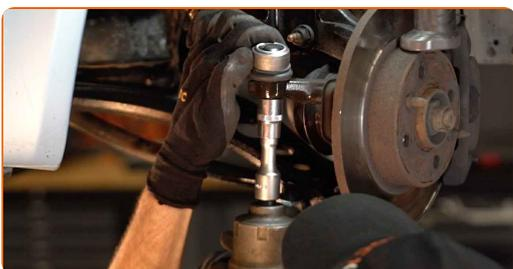
**17** Vissez le contre-écrou de l'embout de biellette de direction. Utilisez une clé mixte de No.20
