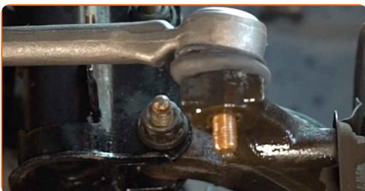
**16** Vissez l'écrou de fixation reliant l'embout de biellette à la fusée d'essieu. Utilisez une douille n° 17. Utilisez une clé à cliquet.
